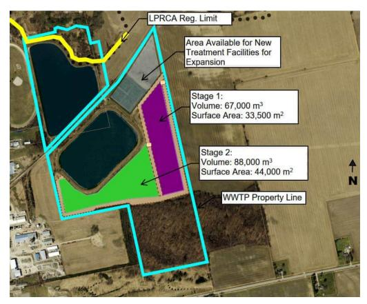
Figure 3.3 Effluent Storage Lagoons
